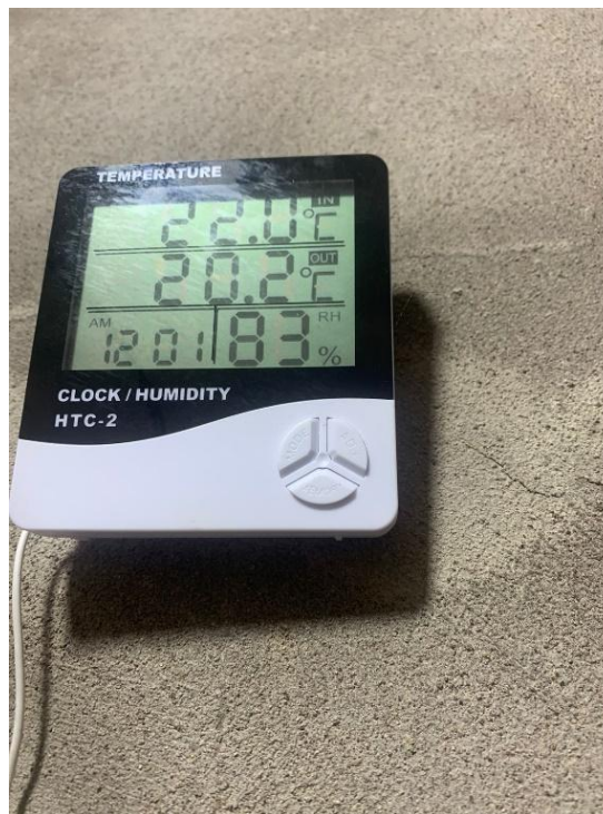
Figura 2. Monitoreo diario de temperatura y humedad relativa mediante termohigrómetro digital.
