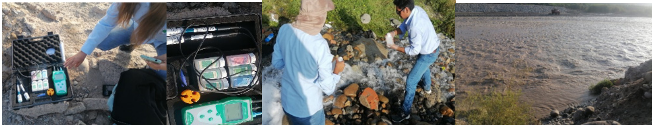
Figura 2. Multiparámetro en el punto de monitoreo AS-02. Descarga de agua residual proveniente de la planta de tratamiento Boca del Río.
