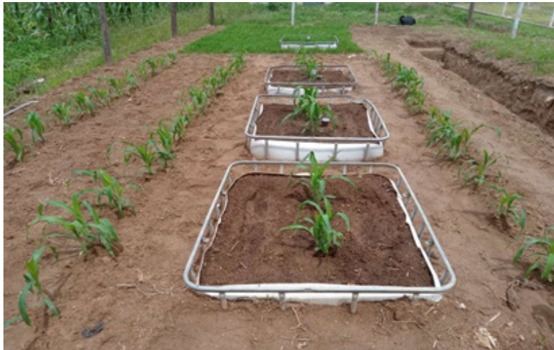
Figura 3. Vista de los lisímetros instalados en el campo de investigación.
